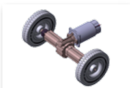
Электрический привод колес с дифференциалом
