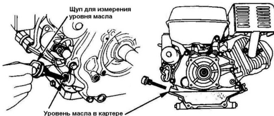
Рисунок 2 – Уровень масла в картере двигателя
