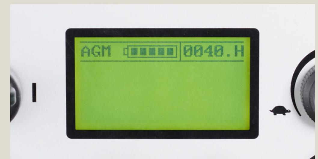
**Ежедневно:** Если индикатор аккумулятора показывает низкий заряд, поставьте ее на зарядку. Аккумулятор необходимо заряжать в случае разрядки, прекращения использования или отсутствия использования в течение следующих 8-10 часов.
