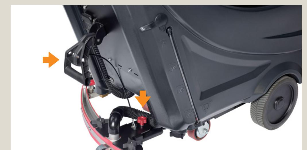
Для подъема или опускания скребка пользуйтесь ручкой. При помощи регулировочного барашка, если необходимо, отрегулируйте угол наклона скребка для лучшего сбора воды.
