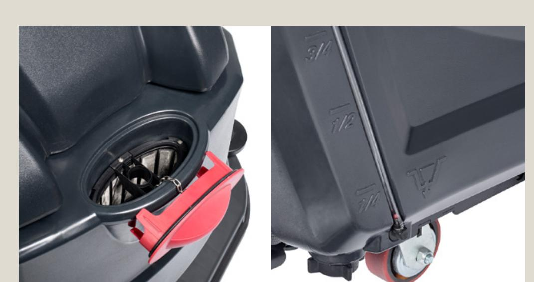
Снимите красную крышку и заполните бак водой, максимальная температура которой должна быть 40С. Добавьте подходящее низкопенное моющее средство. Максимальный объем бака 85 л. Проверьте уровень по красному шарику индикатора уровня на боковой стороне машины.
