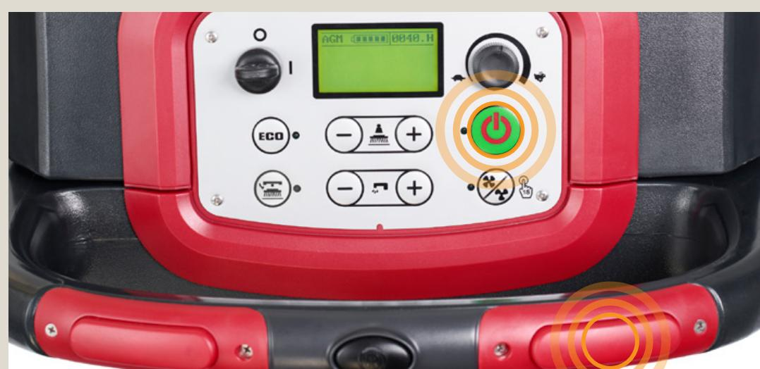
**Установите** держатель щетки / пэда под деку и нажмите кнопку OneTouch™, после чего дека опустится автоматически. Запустится вакуумный двигатель. Установите щетки кратким нажатием одного из двух выключателей.
