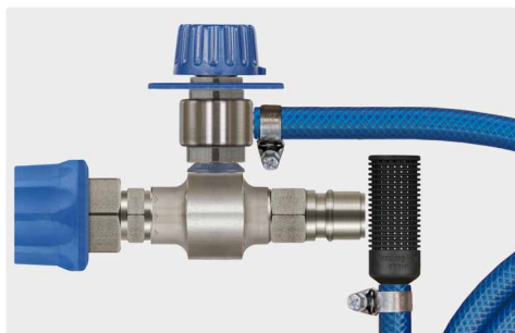
Муфта ST-45-250 нерж. сталь : штекер ST-45-250 нерж. сталь. Инжектор с дозирующим вентилем ST-161, всасывающим шлангом 2.000 мм и всасыв. фильтром ST-31. Макс. 250 bar / 90 °C
