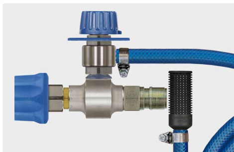
Муфта ST-45-250 никелир. латунь : штекер ST-45-250 оцинк. сталь. Инжектор с дозирующим вентилем ST-161, всасывающим шлангом 2.000 мм и всасыв. фильтром ST-31. Макс. 250 bar / 90 °C
