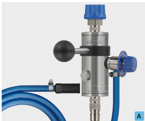
Муфта ST-45-250 нерж. сталь : штекер ST-45-250 нерж. сталь. Инжектор ST-167 с дозирующим вентилем ST-161, всасывающим шлангом 2.000 мм и всасыв. фильтром ST-31. Макс. 250 bar / 100 °C
