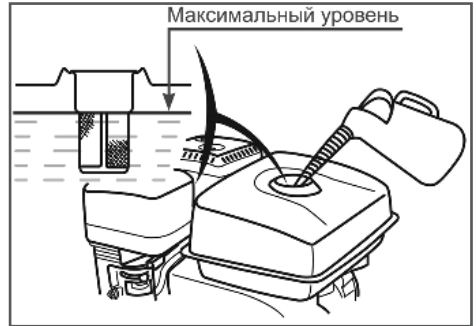
Рис. 5 Максимальный уровень топлива в топливном баке
