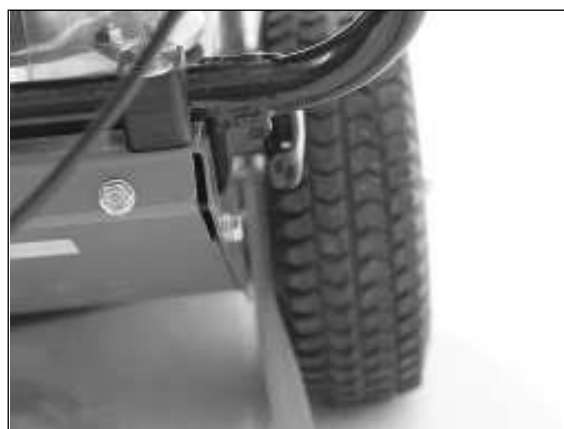
2) Задняя ось служит в качестве точки крепления
