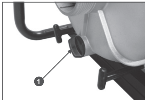
Рис. 19 Расположение пробки отверстия для слива воды из корпуса насоса
