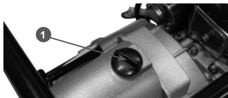
Рис. 13 Расположение пробки отверстия для заливки воды в корпус насоса
