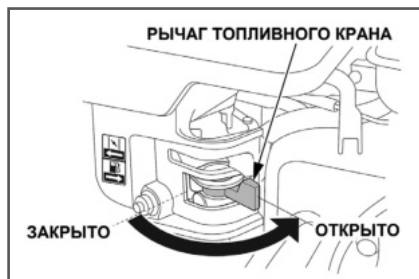
Рис. 11 Рычаг топливного крана
