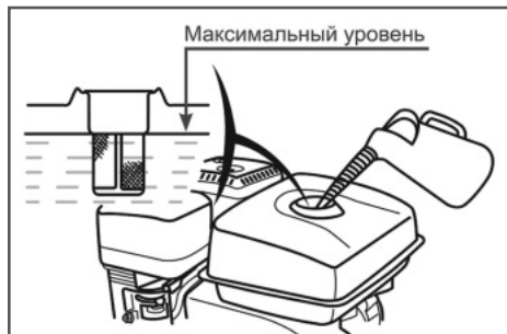
Рис. 6 Максимальный уровень топлива в топливном баке
