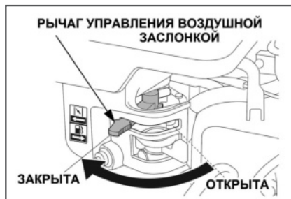
Рис. 10 Рычаг управления воздушной заслонкой
