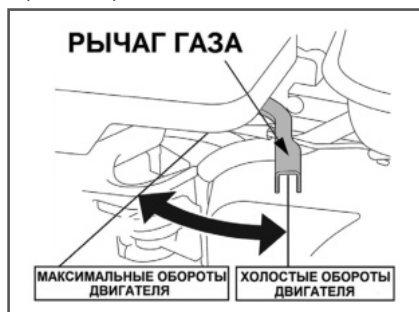
Рис. 12 Положения рычага газа
