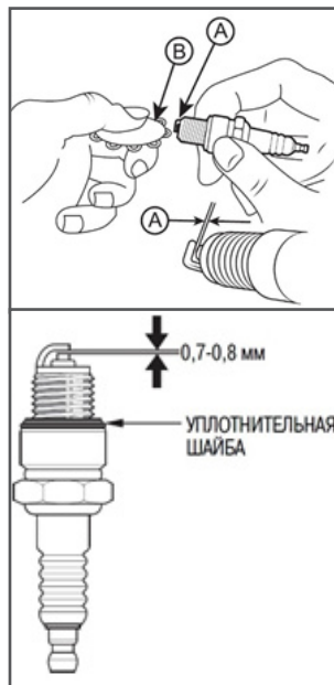
Рис. 23 Зазор между электродами свечи зажигания
