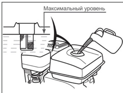
Рис. 7 Максимальный уровень топлива в топливном баке
