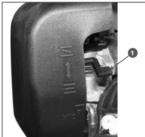
Рис. 6 Расположение рычага управления воздушной заслонкой
