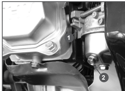
Рис. 18 Слив топлива из карбюратора
