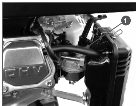
Рис. 12 Трубка системы вентиляции картера
