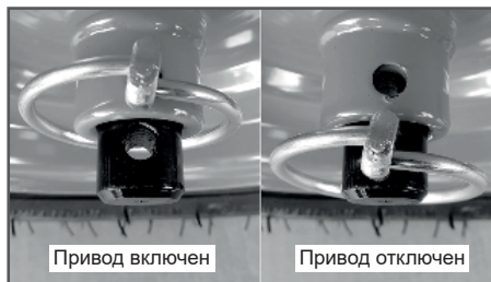
Рис.26 Перестановка шплинта на левом колесе
