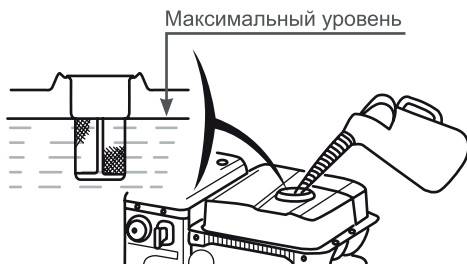
Рис. 14 Максимальный уровень топлива в баке
