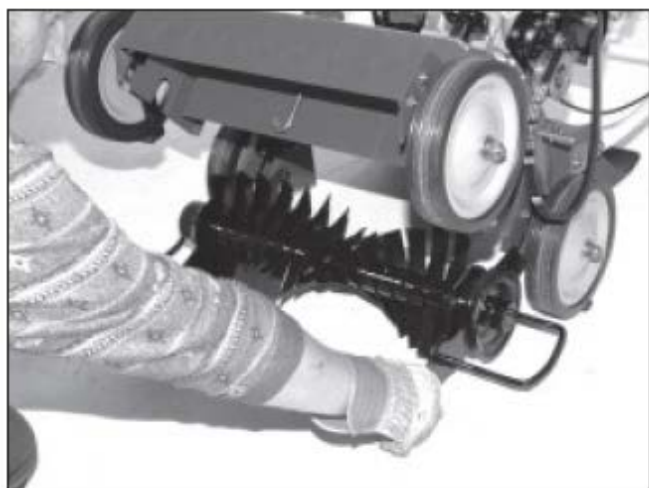
1) Задвинуть узел скarifикатора в корпус
