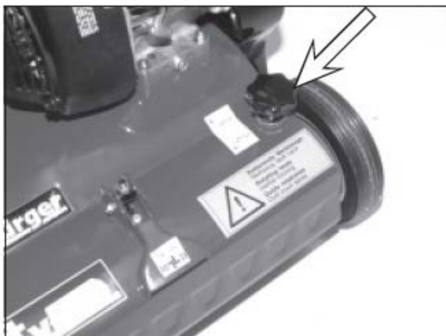
1) Регулировочный винт скарификатора
