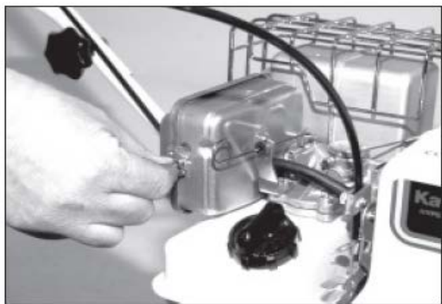
1) Ослабить болт крышки воздушного фильтра.
