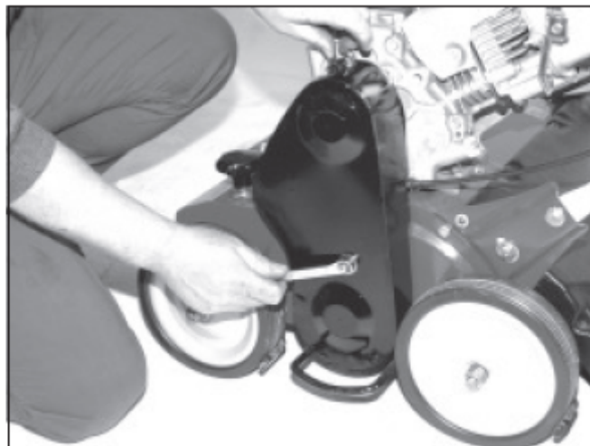
8) Затем установить и прикрутить защиту клинового ремня.
