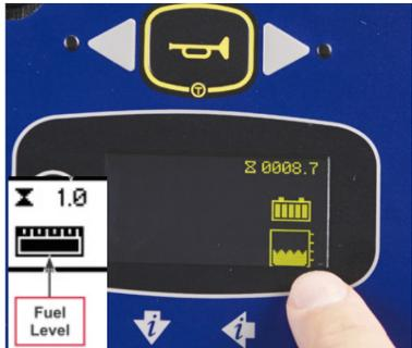
1 Проверьте уровень бака дизельного топлива/ баллона СНГ/ заряд батареи. При необходимости заполните/ замените баллон СНГ/зарядите батареи
