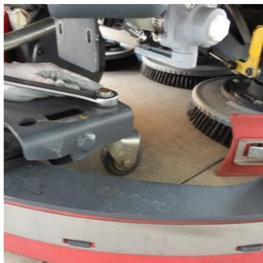
2 Высоту скребка можно отрегулировать поворотными колесами
