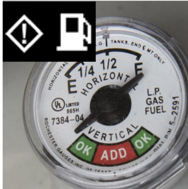
1 Проверьте уровень бака дизельного топлива/ баллона СНГ. При необходимости заполните/замените баллон СНГ
