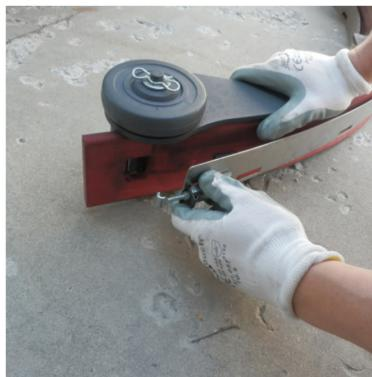
3 Снимите и проверьте лезвия скребка
