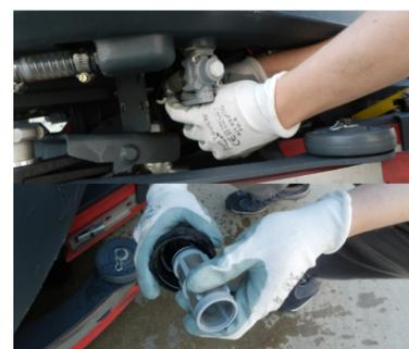
15 Закройте клапан бака раствора, снимите и очистите фильтр. Удостоверьтесь, что уплотнит. прокладка осталась в крышке фильтра
