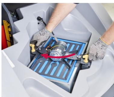
16 Опорожните бункер, снимите и очистите фильтр
