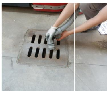
13 Опорожните бак грязной воды с помощью шланга. Затем опорожните бак с раствором с помощью прозрачного шланга
