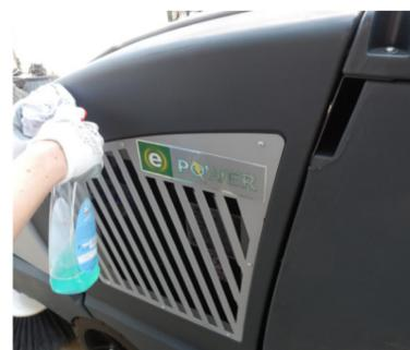
20 Протрите машину влажной тряпкой и припаркуйте ее с открытым баком для грязной воды
