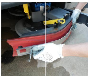
19 Снимите боковые юбки и проверьте степень износа лезвий
