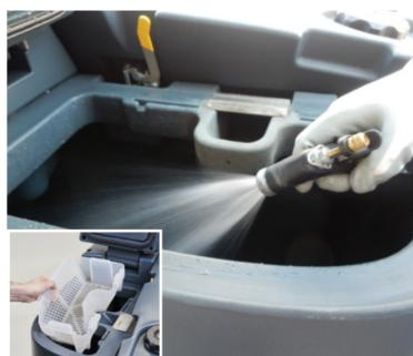
14 Промойте бак грязной воды и решетку чистой водой. Снимите и очистите емкость для мусора.
