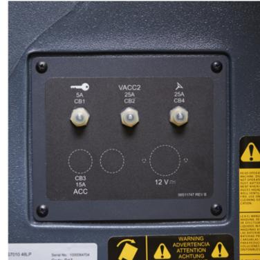
4 Проверьте предохранители
