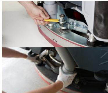
4 Установите и закрепите скребок, затем подсоедините к нему вакуумный шланг. Отрегулируйте высоту и наклон
