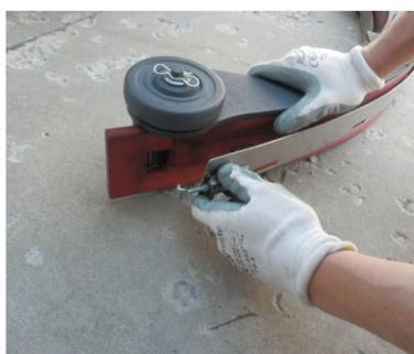
18 Снимите скребок, проверьте степень износа его лезвий
