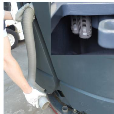
4 Слить бак грязной воды. Проверить всасывающий шланг, и поплавки.
