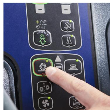
4 Во избежание перегрузки отрегулируйте режим главной щетки по Руководству пользователя. Проверьте щетку и привод на наличие мусора или настр. высоту при перегрузке
